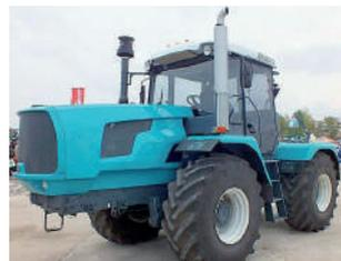
Мал. 135. Трактор ХТЗ-243 Харківського тракторного заводу
